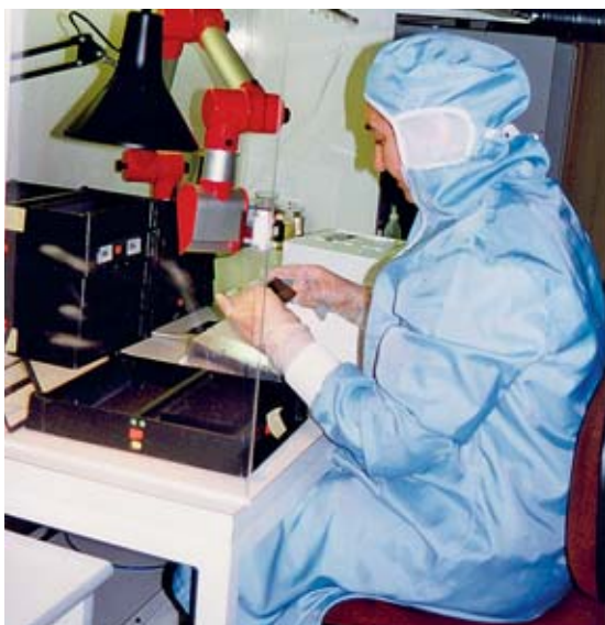
Bild 12: Im Umgang mit Allergenen (hier Klebearbeiten mit Epoxyharz) sind besonders saubere Arbeitsverhältnisse und wirksame Hautschutzmassnahmen sinnvoll.
